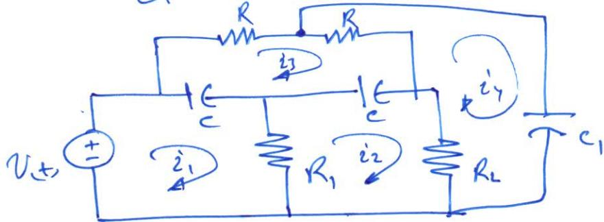
$$\text{Loop-1} \quad V(t) = (i_1 - i_2) R_1 + \frac{1}{C} \int (i_1 - i_3) \cdot dt \rightarrow$$
