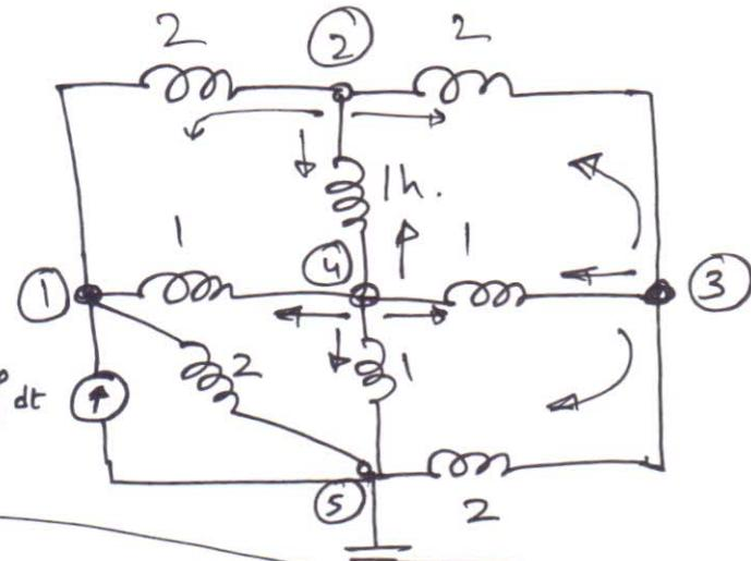
$$i_1 = \frac{1}{2} \int dt = (2 \cdot 0 \int dt) v_1 + (-\frac{1}{2} \int dt) v_2 + (0) v_3 + (-\int dt) v_4$$
