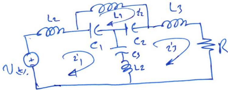
$$\text{Loop-1} \quad V(t) = L_2 \cdot \frac{di_1}{dt} + \frac{1}{C_1} \int (i_1 - i_2) \cdot dt + \frac{1}{C_3} \cdot \int (i_1 - i_3) \cdot dt + L_2 \frac{d(i_1 - i_3)}{dt}$$
