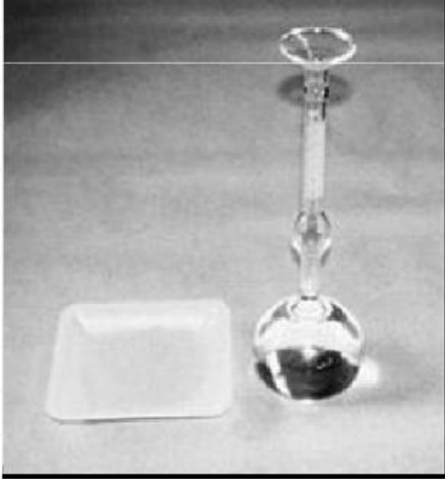
Le Chatelier flask ( ASTM C 188 or AASHTO T 133)
